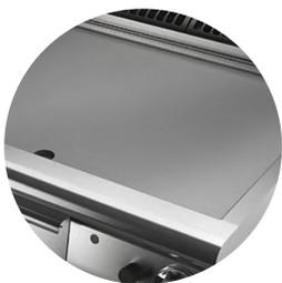
Eine 10-mm-Neigung der Platten zur Vorderseite der Maschine hin ermöglicht einen optimalen Fettabfluss in die Fettauffangwanne.
