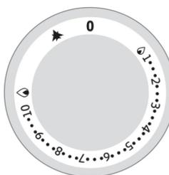
Dans les versions avec robinet, la puissance est réglée par un robinet alimenté de type 22PP qui peut être actionné en continu pour adapter la chaleur de la plaque au type de cuisson.
