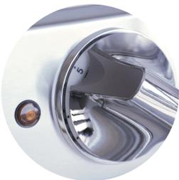
La temperatura se regula mediante un selector de 7 posiciones, y en el salpicadero hay un testigo que indica la activación de la calefacción.
