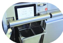
Becken zum Ablassen des gekochten Produkts in den Tank. Garantierte Sauberkeit der Station und einfacher Transport der Produkte.
