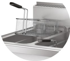
Dans la friteuse à gaz, le brûleur est extérieur à la cuve et est en acier inoxydable avec une flamme stabilisée. Allumage piézoélectrique et sécurité assurée par un robinet avec thermocouple et flamme pilote.
