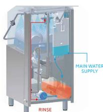
Rinçage à pression stabilisée et température constante de l'eau de la chaudière de 85°C. Grâce à la chaudière atmosphérique, le mélange de l'eau du réseau dans la phase de rinçage est évité. Le système PLUS permet également un meilleur contrôle et un dosage correct du produit de rinçage à chaque cycle.
