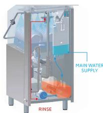
Stabilisierte Druckspülung und konstante Kesselwassertemperatur von 85°C. Dank des atmosphärischen Boilers wird eine Vermischung des Leitungswassers in der Nachspülphase vermieden. Das PLUS-System gewährleistet außerdem eine bessere Kontrolle und die richtige Dosierung des Klarspülers bei jedem Zyklus.
