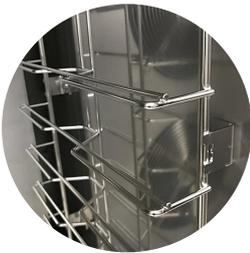
Support porte-plaques en acier inoxydable AISI 304, avec guides amovibles ANTI-BRIDGE en acier inoxydable AISI 304, s'emboîtant tous les 20 mm pour GN1/1 ou 600x400.
