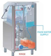
Risciacquo a pressione stabilizzata e temperatura costante dell'acqua del boiler a 85°C. Grazie al boiler atmosferico si evita la miscelazione di acqua di rete nella fase di risciacquo. Il sistema PLUS inoltre, garantisce un maggior controllo ed il corretto dosaggio di brillantante ad ogni ciclo.
