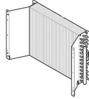
Serpentin d'évaporation en cuivre-aluminium, avec traitement anti-corrosion par cataphorèse, avec déflecteur d'ouverture à charnière pour le nettoyage
