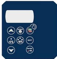
Mando electrónico de membrana. Panel de control organizado IPX4 de fácil acceso y montado en la parte frontal.
