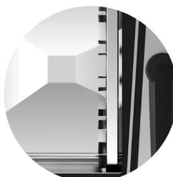
Puerta de cristal templado con ventilación posterior, doble acristalamiento con cámara de aire y cristal interior termorreflectante para reducir la radiación de calor al operario y aumentar la eficiencia.
