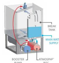
PLUS SYSTEM Spülen bei konstanter Temperatur und konstantem Wasserdruck
