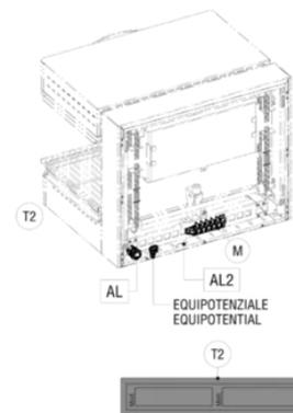
AL\_ Entrata cavo elettrico | Power supply cable inlet | Netzkabeleingang | Entree cable électrique | Entrada cable eléctrico.
